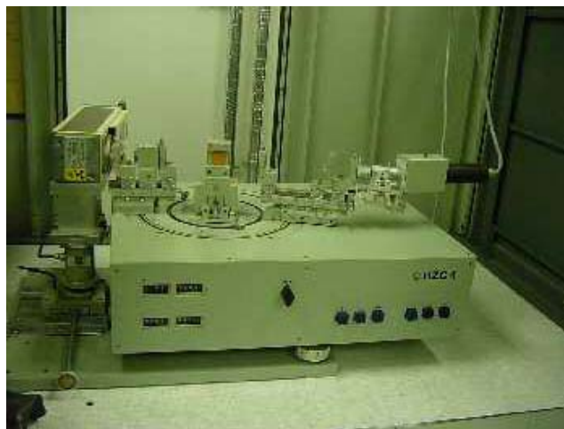
Figura 1.12: Difratômetro HZG4 usado neste trabalho. O tubo de raios X aparece à esquerda e o detector, à direita. Ao centro está o porta-amostras.
