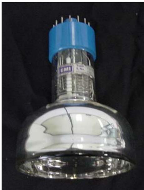
Figura 3-3: Foto de uma PMT EMI tipo 9791KB 6597 utilizada no tanque protótipo.
