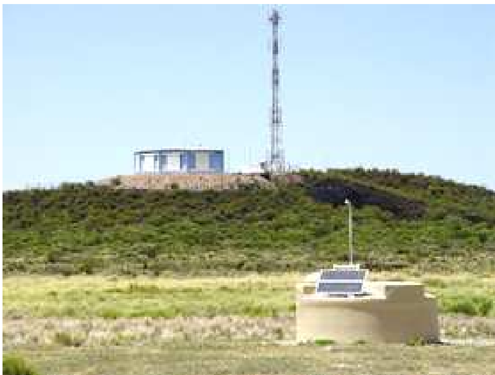
Figura 3.6: Sítio sul em Malargue - detector de superfície, ao fundo - o telescópio de fluorescência e o LIDAR.
