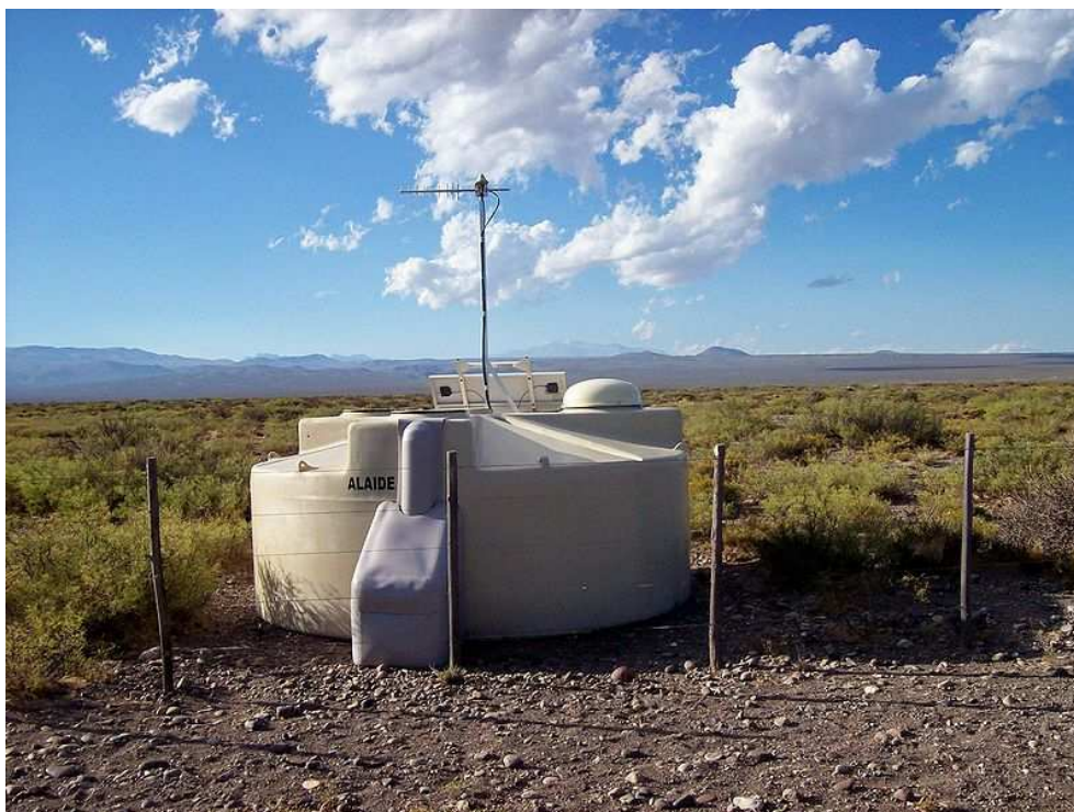
Figura 3.3: Detector de superfície do Observatório Pierre Auger instalado no sítio Sul, em Malargue.
