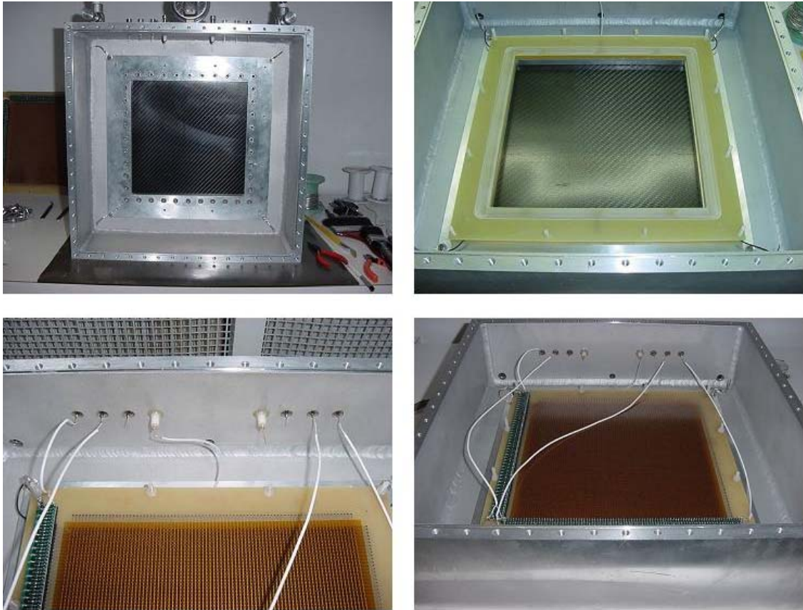
Figura 3-17: Fotos da montagem do detector proporcional de grande área (DPGA)
