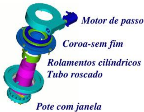
Figura C.1: Estrutura central do FPD
