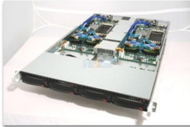
**Figura 5.1:** Visão do *hardware* computacional utilizado nas avaliações das tecnologias de paralelismo. A imagem mostra a visão de duas placas mães Supermicro com 2 processadores Xeon E5550 e 8GB de memória RAM-ECC DDR2-800, em cada placa mãe.
