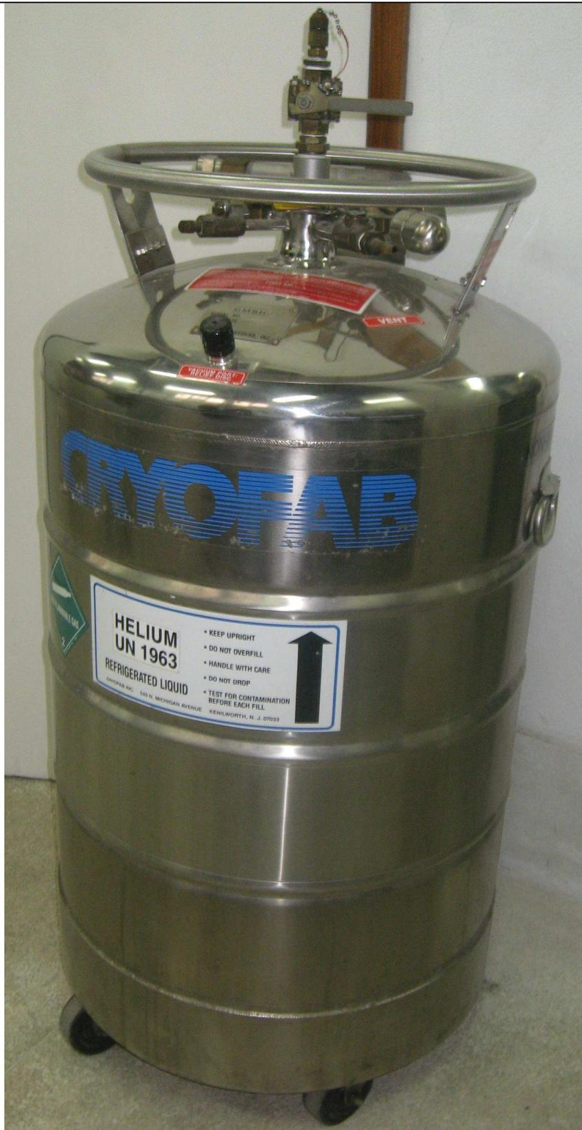
Figura 4.2-6 Reservatório criogênico *dewar*, modelo CMS-60 com capacidade de 60 litros de hélio líquido, fabricado pela Cryofab, onde é inserido o insert
