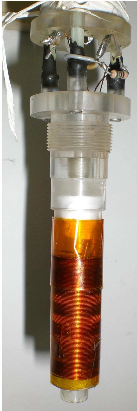
**Figura 4.2-9 Bobina para a aplicação dos pulsos eletromagnéticos, indutância 100  $\mu$ H aproximadamente.**
