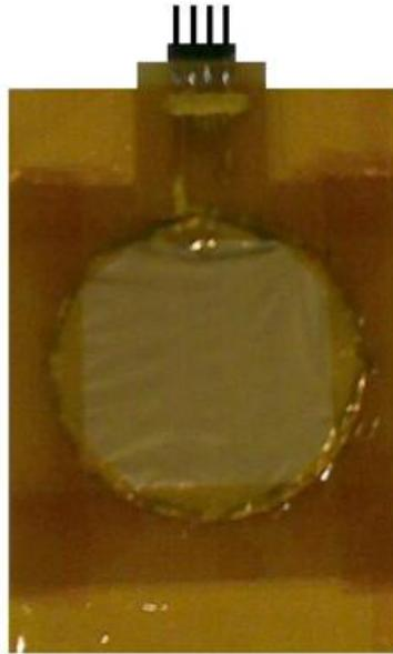
Figura 4.7: A membrana fixa ao suporte e envolta pela fita Kapton, a qual permite a exposição à solução apenas a região de interesse da membrana.
