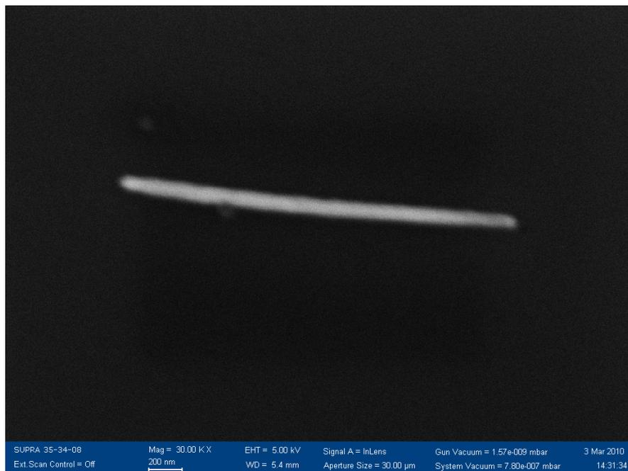
Figura 4.14: Nanofio individual de cobalto com aproximadamente  $2,4 \mu m$  de comprimento e  $90 nm$  de diâmetro.
