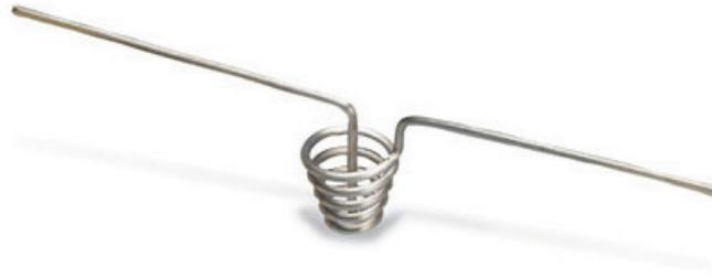
Figura 4.4: O fio de metal ou filamento de tungstênio é moldado em uma cesta invertida cônica. Eles são usados para aquecer os cadinhos com porções maiores de metais a serem evaporados.
