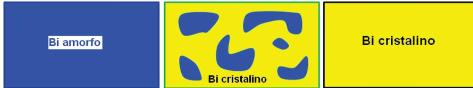
Figura 5.7: Modelo de Bi puro depois de duas etapas de aquecimento, onde depois do tratamento térmico as ilhas supercondutoras são formadas. Figura adaptada de [80]
