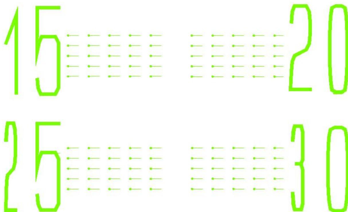
Figura 5.8: Desenhos feitos no programa GDSII VIEWR que são transferidos pela LFE para o substrato. Os números ao lado são utilizados para identificar as amostras de diferentes geometrias.
