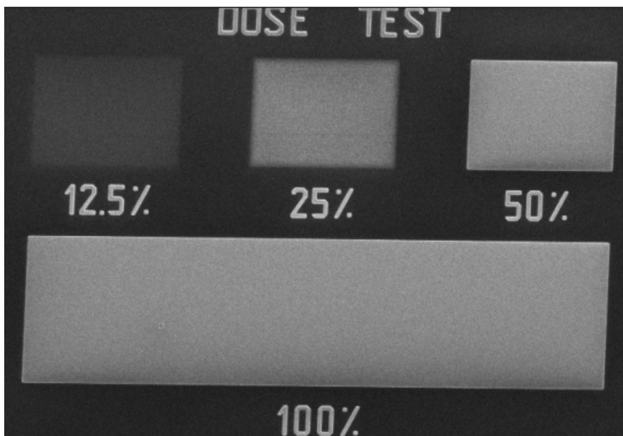
Figura 5.9: Estruturas fabricadas para teste dose. A dose é escolhida observando a largura dos retângulos com a dimensão mais próxima do desejado.
