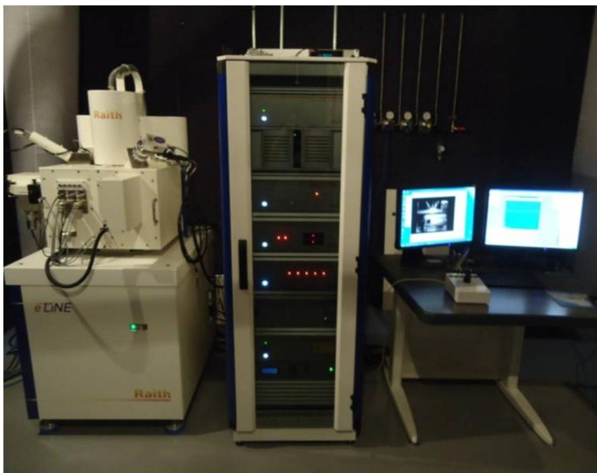
Figura 5.7: Sistema de Litografia por Feixe de Elétons do Labnano/CBPF.
