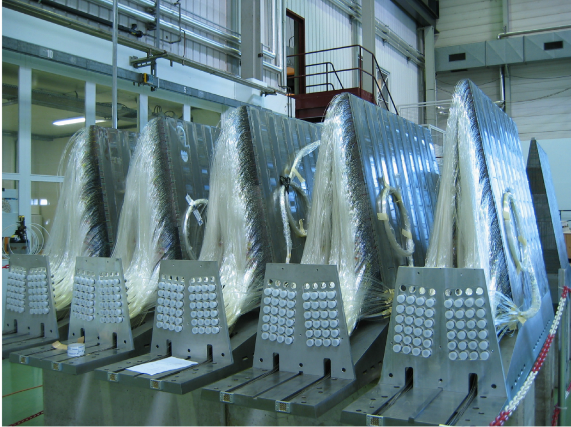
Figura 4.11: Cunhas de ferro que compõem o calorímetro hadrônico frontal.
