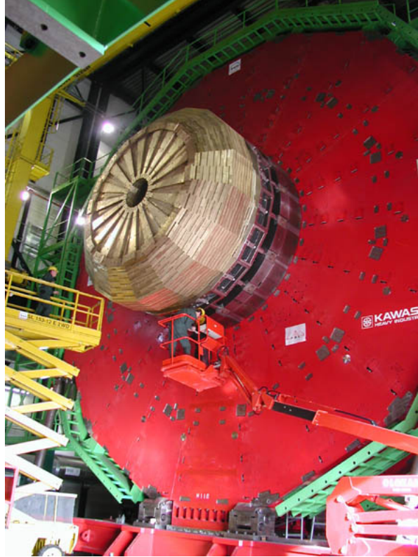
Figura 4.10: Instalação de uma das tampas do HCAL.
