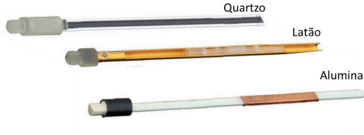
Figura 3.6: Diferentes porta amostras para o uso no do módulo VSM no PPMS da Quantum Design, na ordem de cima para baixo estão o porta amostra de quartzo, latão e alumina.
