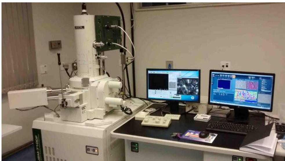
Figura 19 – Microscópio eletrônico de varredura (JEOL JSM-7100F) LABNANO/CBPF.
