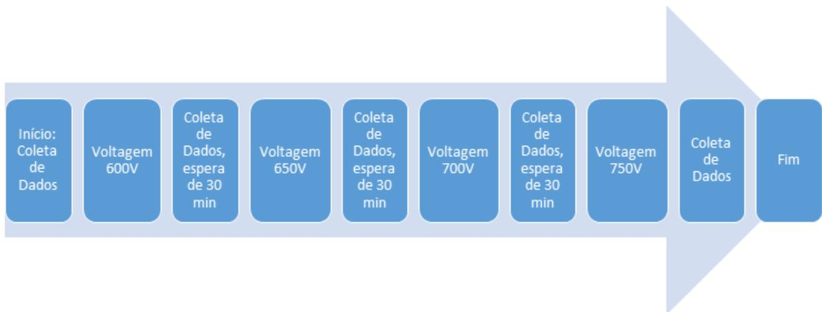
Figura 3.24: Resumo das diferentes etapas durante a tomada de dados para cada configuração de intensidade de luz.
