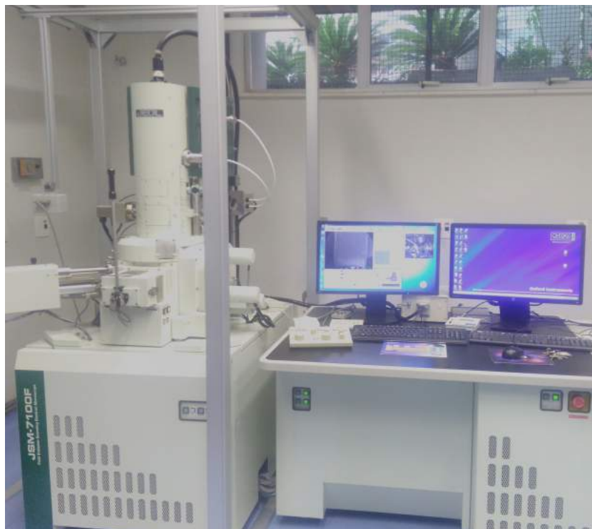
Figura 4.8 – Microscópio eletrônico de varredura com emissão de campo (MEV-FEG) de alta resolução JEOL, modelo JSM-7100F, do LabNano – Laboratório de Nanociência e Nanotecnologia, CBPF.
