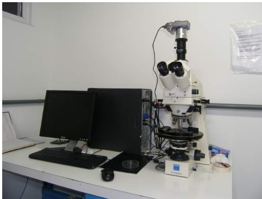
Figura 4.6 – Microscópio óptico metalográfico universal trinocular, marca Zeiss, modelo Axioplan.
