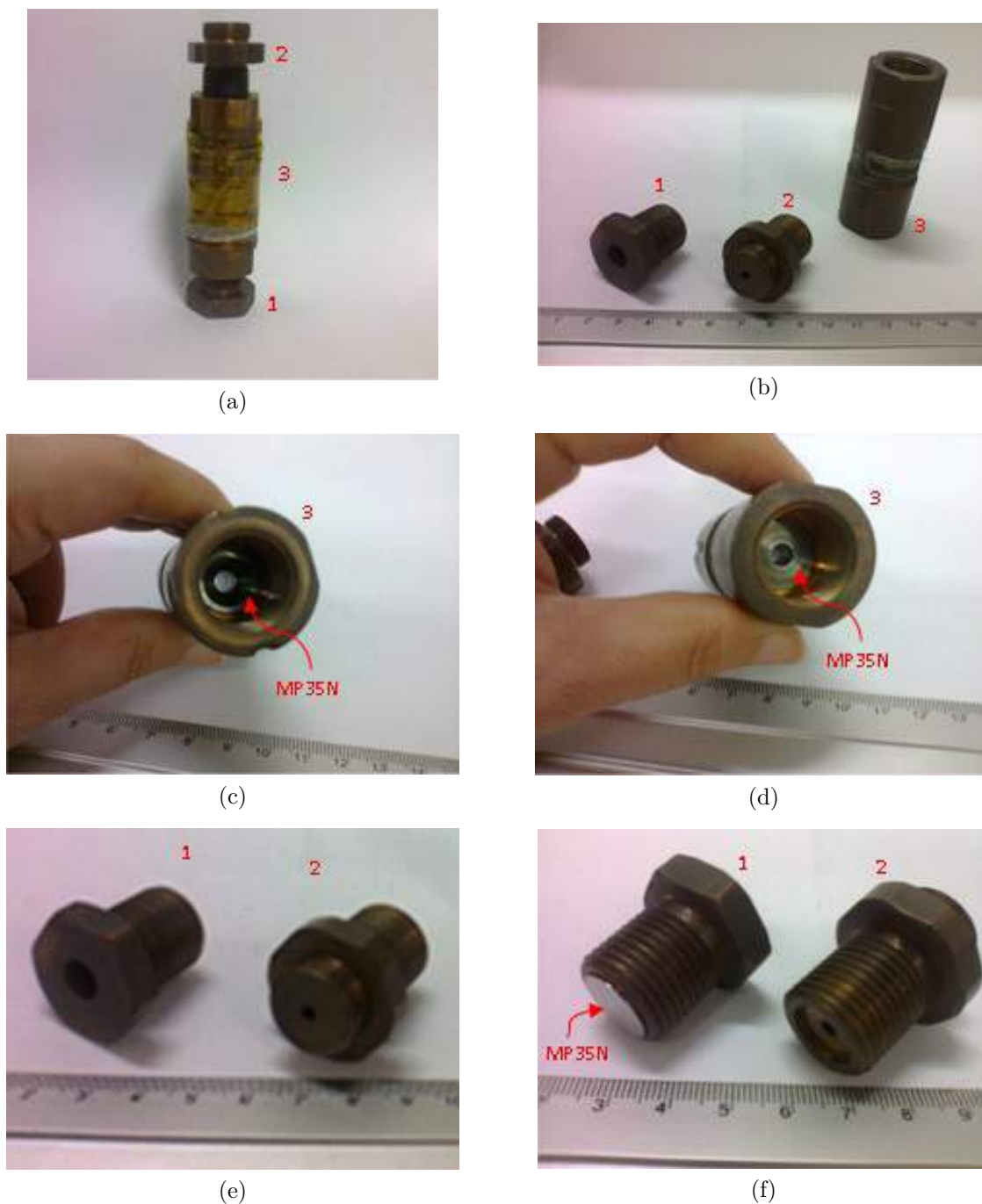
Figura 4.17 – Célula de pressão tipo “clamp” de 25 kBar: (a) Célula montada: 1 e 2 são os parafusos que fecham o corpo principal 3; (b) célula desmontada: parafusos e corpo principal; (c) e (d) detalhes do interior do corpo central; (e) e (f) detalhes dos parafusos: vê-se o detalhe da pastilha móvel de MP35N no parafuso 1 que é usada para aplicar pressão dentro da célula.
