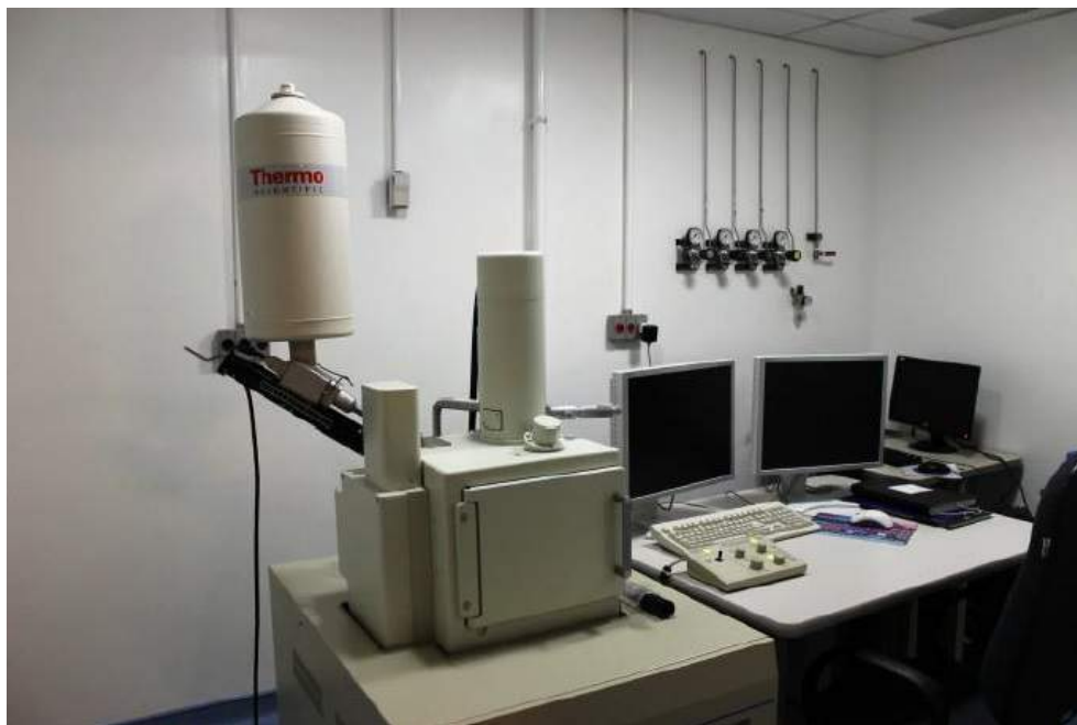
Figura 4.3 – Microscópio eletrônico de varredura (MEV) analítico de baixo vácuo JEOL, modelo JSM-6490LV, do LabNano – Laboratório de Nanociência e Nanotecnologia, CBPF.
