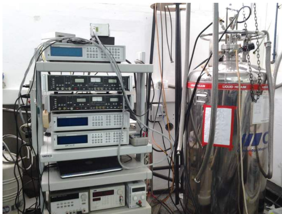
Figura 4.15 – Sistema de medida ADR ( Adiabatic Demagnetisation Refrigerator ), do Laboratório de Resistividade, que alcança temperaturas até 50 mK, onde medidas de resistividade em pressão ambiente e sob pressão hidrostáticas foram realizadas.
