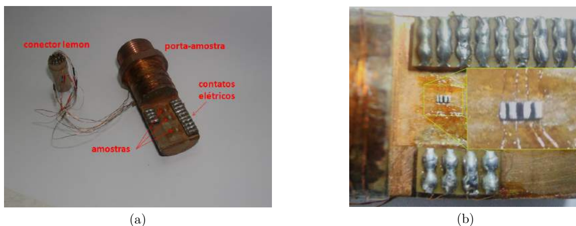
Figura 4.16 – Porta-amostra do ADR para medidas em pressão ambiente: (a) Disposição de três pedaços da amostra instalados; (b) detalhe de um dos pedaços da amostra.
