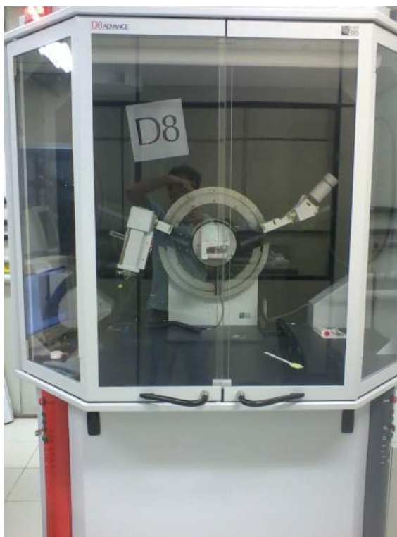
Figura 4.1 – Difratorômetro Bruker D8 Advance II, do LDRX –Laboratório Regional de Difração de Raios X, Instituto de Física da UFF– Universidade Federal Fluminense.
