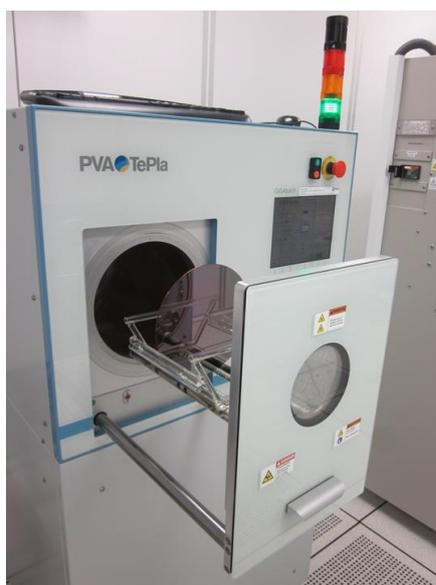
**Figura 5.9** – Sistema para remoção de resiste PVA TEPLA Plasma Asher.
