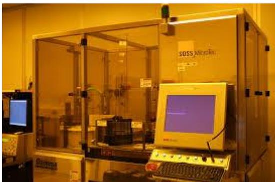
**Figura 5.13** – Sistema para aplicação de resiste e revelação, Optical Photoresist, SUSS Gamma.
