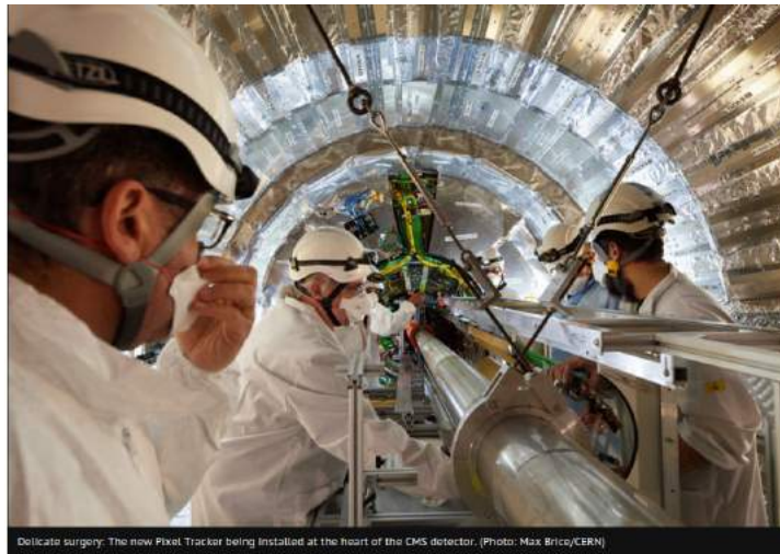
Figura 4.8: A substituição de parte do núcleo do experimento CMS, seu detector de Pixels de Si. Alteração necessária devida a nova era de altas luminosidade que será experimentada pelo detector CMS[94].
