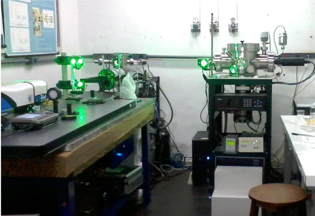
**Figura 4.2:** Montagem experimental para a produção dos recobrimentos de HAP: laser Nd:YAG, espelhos e lentes para  $\lambda=532$  nm e a câmara de deposição por PLD.
