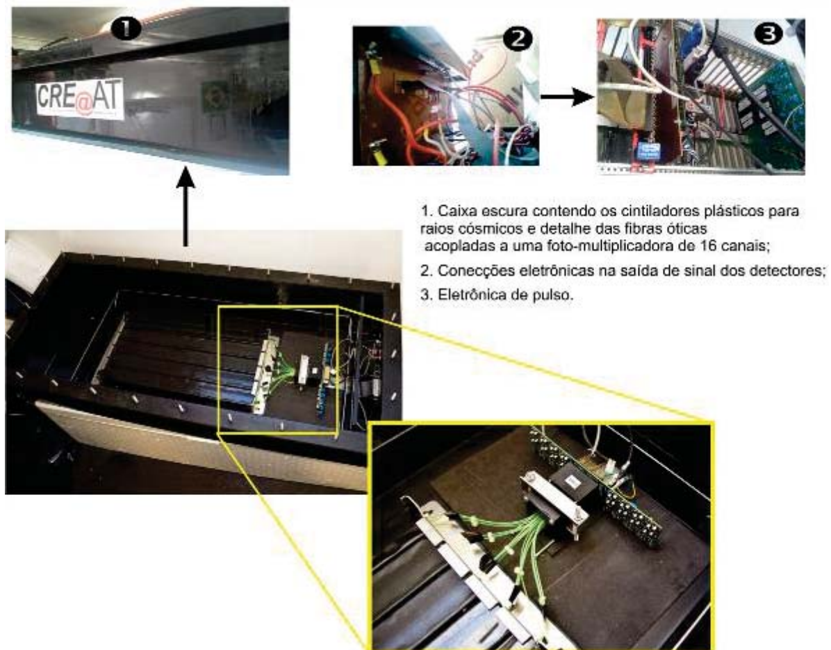
Figura 20 – Eletrônica de detecção e sinal para múons no Criosfera 1.
