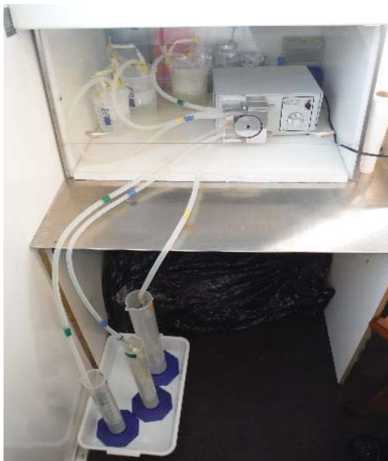
Figura 24 - Sistema de filtragem instalado no Criosfera 1 para concentração de microorganismos e particulados da amostras de neve/firn coletadas no pit.
