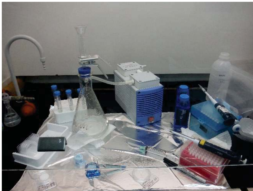
Figura 27 - Sistema de filtragem de amostras para observação de microorganismos e particulados em microscópios eletrônico e de epifluorescência. O procedimento foi realizado no INACH, Punta Arenas, Chile.
