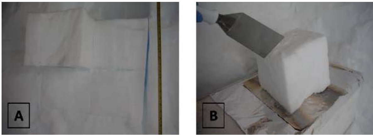
Figura 26 - Coleta das amostras de neve/firn no CrioLab. (A) Bloco de neve/firn extraído da parede do pit; (B) Processo de descontaminação do bloco para armazenamento em sacos estéreis.
