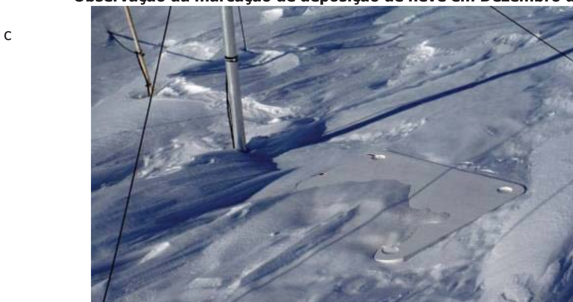
Figura 12 – (acima) Colocação da placa para acúmulo anual de neve sob o sensor SR50A; (abaixo) acúmulo anual de neve em Dezembro de 2014.
