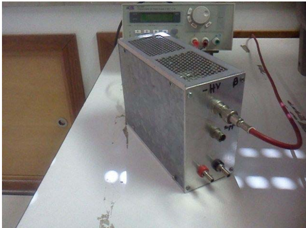
Figura 8: Foto do protótipo desenvolvido da fonte de alta tensão negativa.
