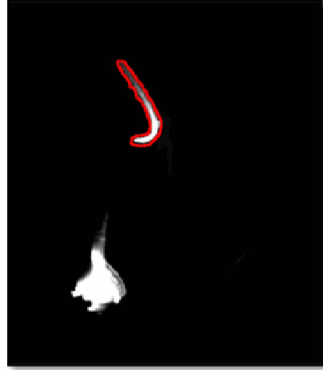
FIG. 8: Exemplo de detecção em uma imagem de fusão nuclear da região de MARFE [Murari, 2010].
