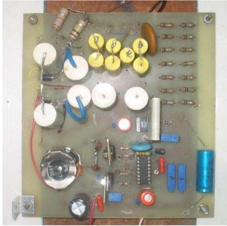
Figura 7 – Foto do protótipo desenvolvido da fonte de alta tensão positiva.
