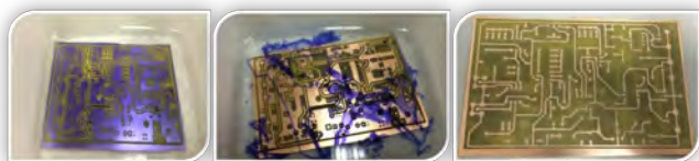
Figura 13: Remoção do dryfilm residual escuro utilizando solução de soda cáustica.
