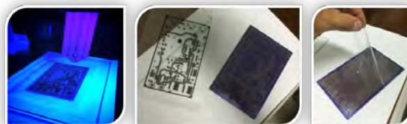
Figura 8: Processo de fotografia. Nota-se claramente o layout do circuito gravado no dryfilm e a película plástica protetora sendo removida.
