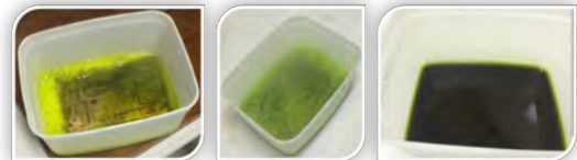
Figura 11: Soluções de corrosão em proporções inadequadas. Seu uso pode acarretar danos irreversíveis a placa.
