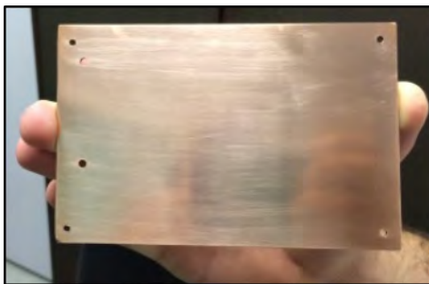
Figura 5: Placa limpa, com os furos de sincronismo e pronta para a receber o dryfilm .
