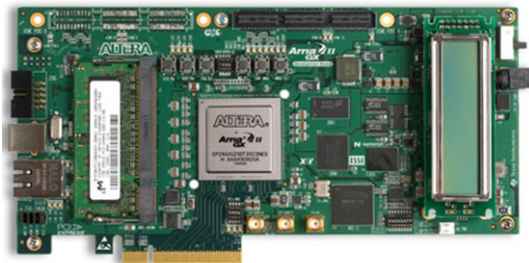
Figura 5: Kit Arria II GX utilizado para o desenvolvimento do firmware .
