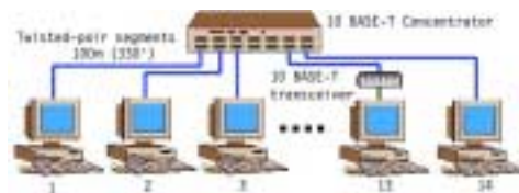
Topologia em estrela com cabo de par trançado
