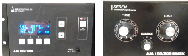
Figura 3: Conjunto Fonte de RF AJA 100/300 e acoplador de impedância
