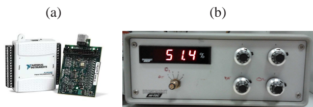
Figura 4: (a) Placa de aquisição de dados Daq NI 6008, (b) Controlador de fluxo de massa Bronkhorst
