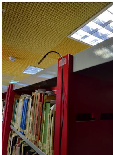
Figura 20: Sensor de Temperatura alocado na lateral da estante 2
