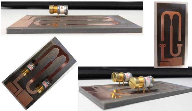
FIG. 9: Microressoador planar fabricado para operar em alto campo, sintonizado em 500MHz
