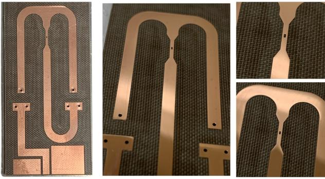
FIG. 8: Ressonador antes do polimento à esquerda. Ao centro e à direita, vemos o ressonador polido. Imagem produzida no CBPF.
