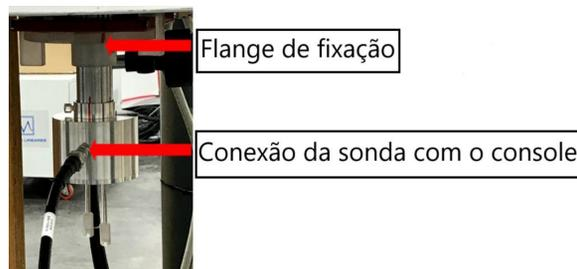
FIG. 15: Destaque para o flange de fixação e para a interligação do sensor ao console do espectrômetro.
