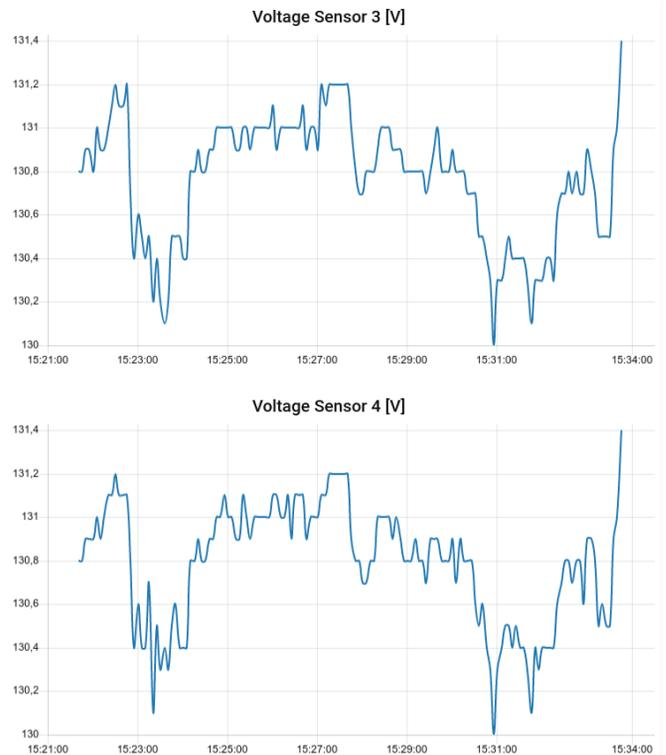
Figura 16: Tensão medida pelos sensores 3 e 4.
