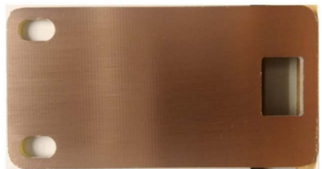
Figure 6: Placa de cobre já cortada nas medidas projetadas e limpa.
