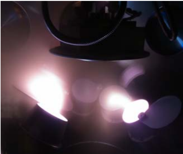
Figura 26: Plasma gerado pelos magnetrons durante a codeposição.
