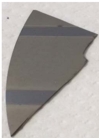
Figura 27: Amostra final, substrato de Si(100) depositado com a liga Cu-Ni por codeposição.
