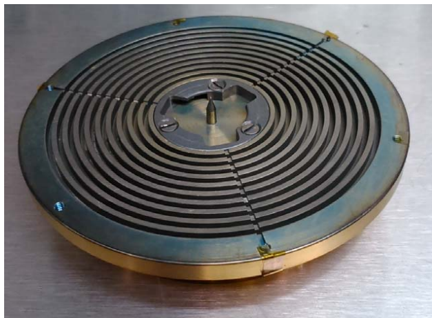
Figura 18: Verso do porta-amostra, mostrando o rebaixo para a entrada do eixo do motor.
