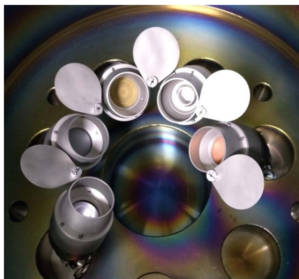
Figura 10: Os magnetrons, com os alvos, no interior da câmara de vácuo.
