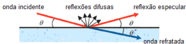
Figura 3: Refração e reflexão na superfície de um material. Compilado de [4].
