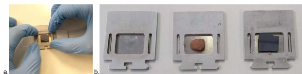
Figura 20: a) alinhamento da amostra ao porta-amostra do difratômetro; b) porta-amostra, com a massa de modelar, e com a amostra posicionada.
