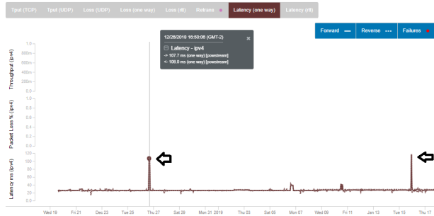
Figura 9: Teste de Latência de Sentido único ( Latency on way ) do trecho CBPF-Reuna.
