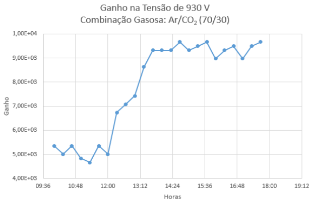
Figure 17: Figura 17. Variação do ganho usando um pré-amplificador de carga, durante oito horas, para a mistura gasosa Ar/CO 2 (70/30).
