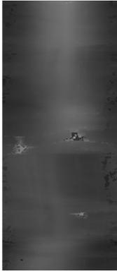
Figura 2: Trecho de imagem acústica de Tempo de Trânsito referente ao mesmo trecho apresentado na figura 1. Dado obtido de [9]
