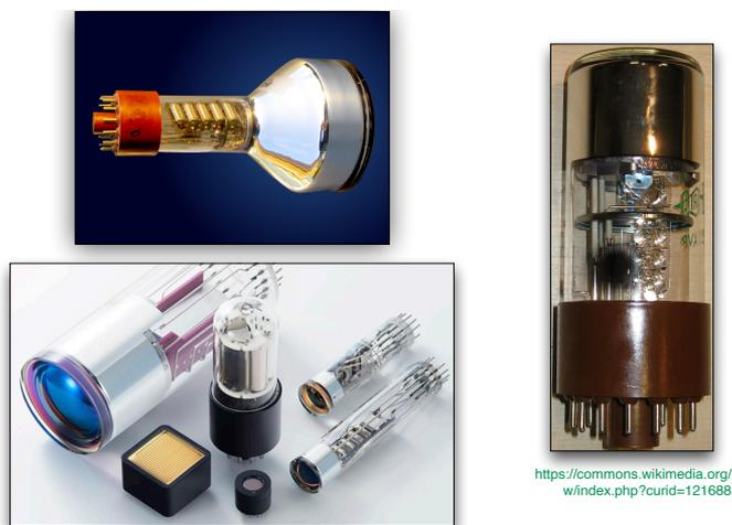
Figura 16: Vários tipos de PMTs. Abaixo e à esquerda vemos também dois tipos de SiPM.
