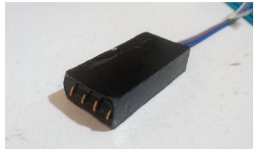
Figura 2: Célula de quatro eletrodos elaborada.
