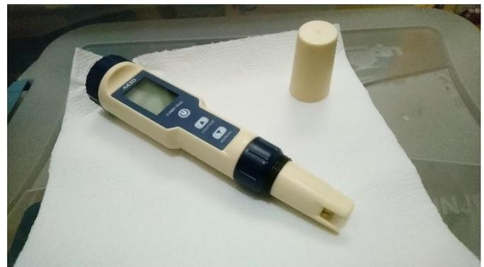
Figura 8: Medidor multiparâmetro comercial com condutivímetro.
