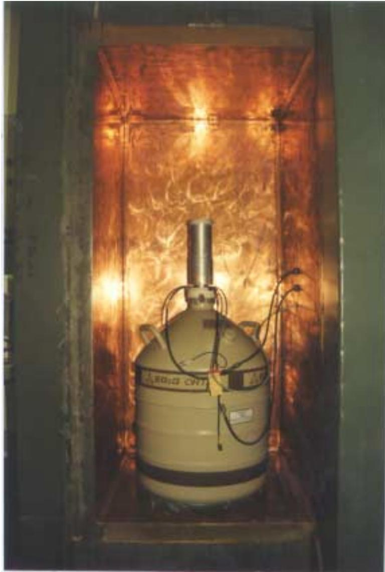
**Fig. 2 – Fotografia detalhada da blindagem de chumbo, incluindo o detector com o seu criostato**
