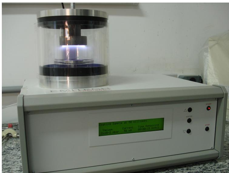
Figura 5.2: Foto do mini-*sputtering* utilizado para fazer os depósitos dos filmes de platina.
