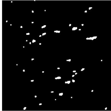
Figura 5.15: Fragmento segmentado e filtrado por área após abertura morfológica com elemento estruturante  $v = [-2, 2] \times [-2, 2]$ . Quando comparado com a Figura 5.14, fica evidente a eficiência desta operação morfológica no que diz respeito à remoção dos segmentos de linha outrora preservados.
