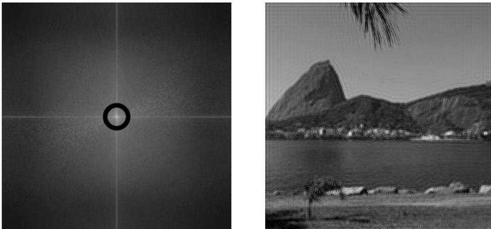
Figura 3.18: Espectro discreto de potência do produto entre a DFT da imagem original e o filtro passa-banda (esquerda) e a imagem reconstruída por inversão da DFT (à direita). Nesse caso, há a preservação de um intervalo fechado de frequências, permitindo a associação das características básicas dos filtros passa-baixas e passa-altas. A origem dos eixos das frequências está localizado no centro da imagem do espectro.
