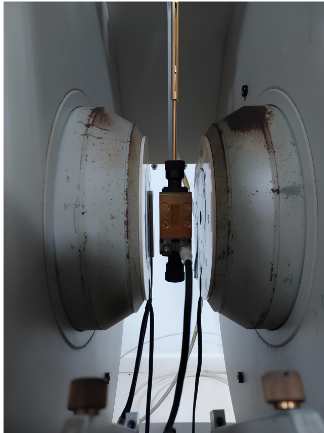
Figura 3.12. Cavidade ressonante utilizada para as medições, nas laterais estão localizadas as bobinas para geração do campo magnético DC.
