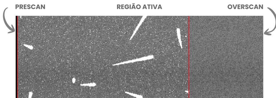
Figura 3.7 – Imagem de Skipper-CCD com as três regiões. A região delimitada à esquerda é o prescan (formada por 8 colunas), no centro temos a parte ativa (que nesta imagem possui 341 colunas) e à direita o overscan (formada por 70 colunas).
