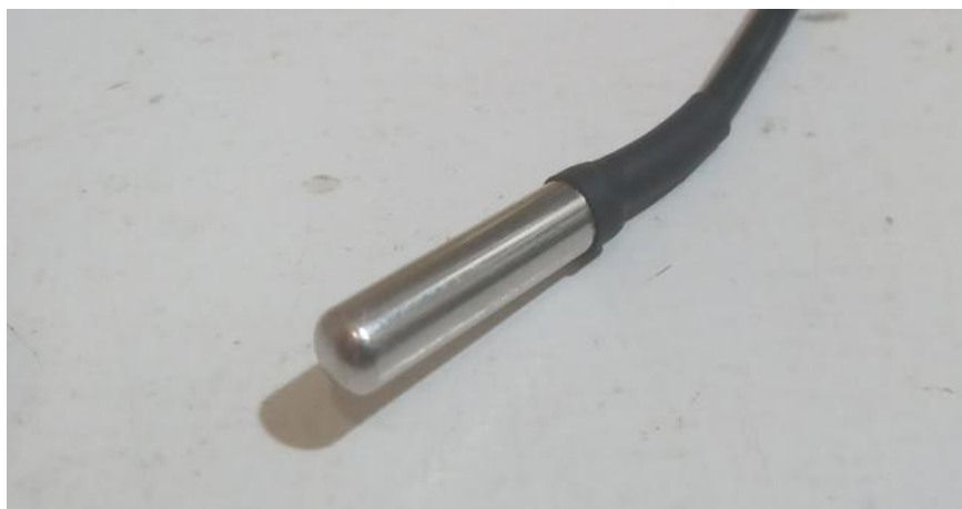
Figura 3-11: Cápsula de aço inox com sensor de temperatura DS18B20 inserido.
