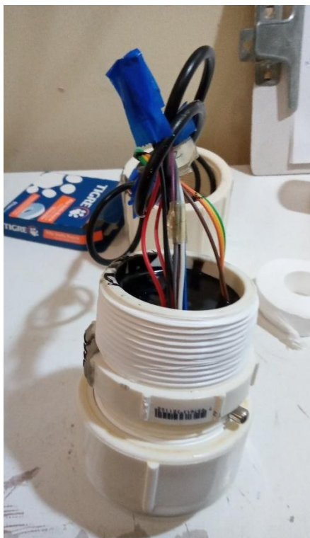
Figura 3-2: Foto do conjunto formado pelas seções central e inferior da sonda \mu CTD.
