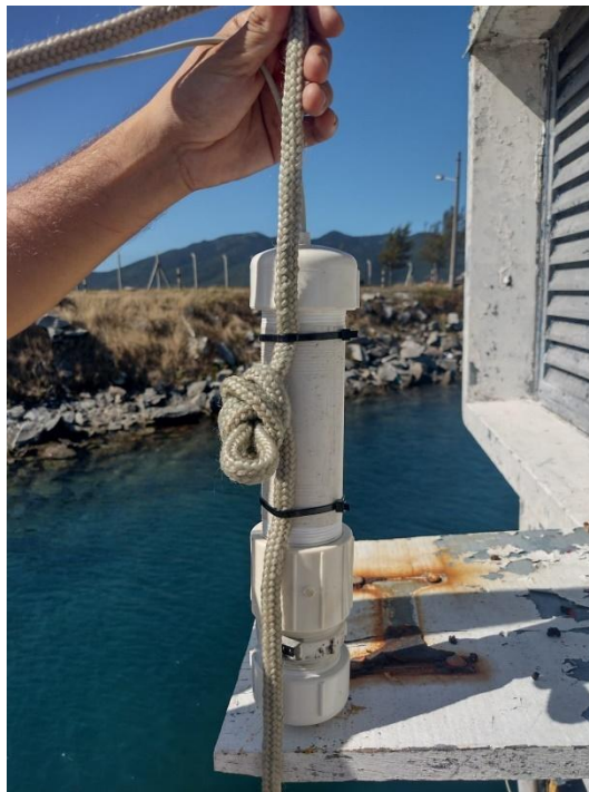
Figura 4-12: Sonda \mu CTD presa em campo para teste em capo na estação marégrafa do Cais do Anel.
