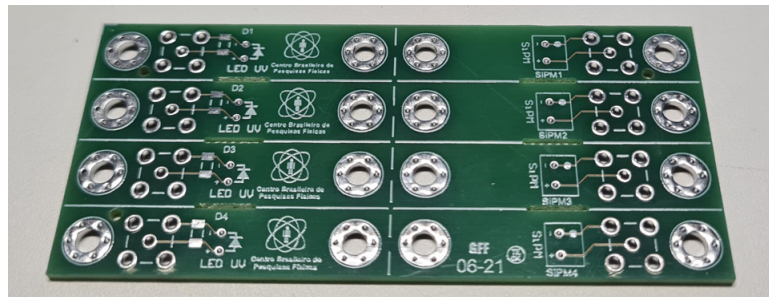
Figura 2.11: Placa utilizada para envio de sinal aos LEDs e extrair sinal dos SiPMs.
