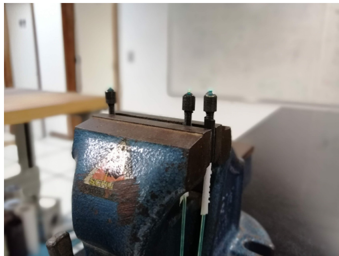
Figura 10: Parafuso preso no torno em pé para evitar que a cola escorresse
