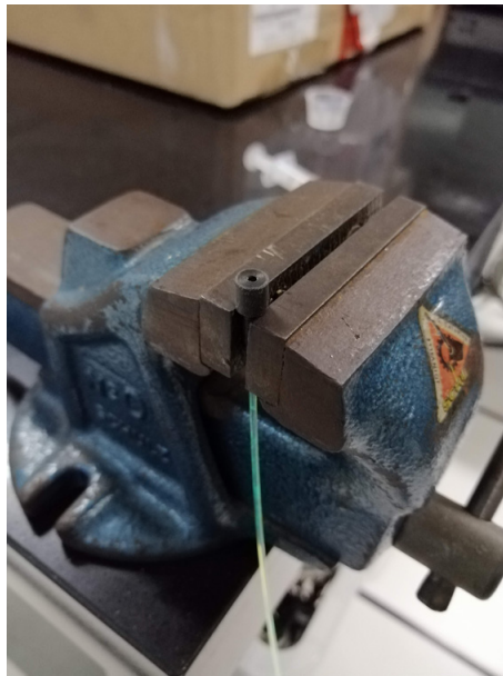
Figura 8: Parafuso pronto para receber a cola
