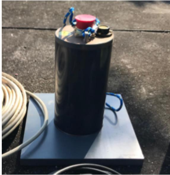
**Figura 7.2.2 - Sensor magnético do tipo fluxgate**
