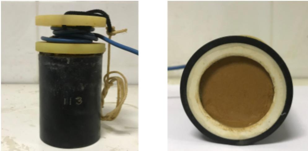
**Figura 7.2.3 - Eletrodos não-polarizáveis utilizados na aquisição de dados MT**
