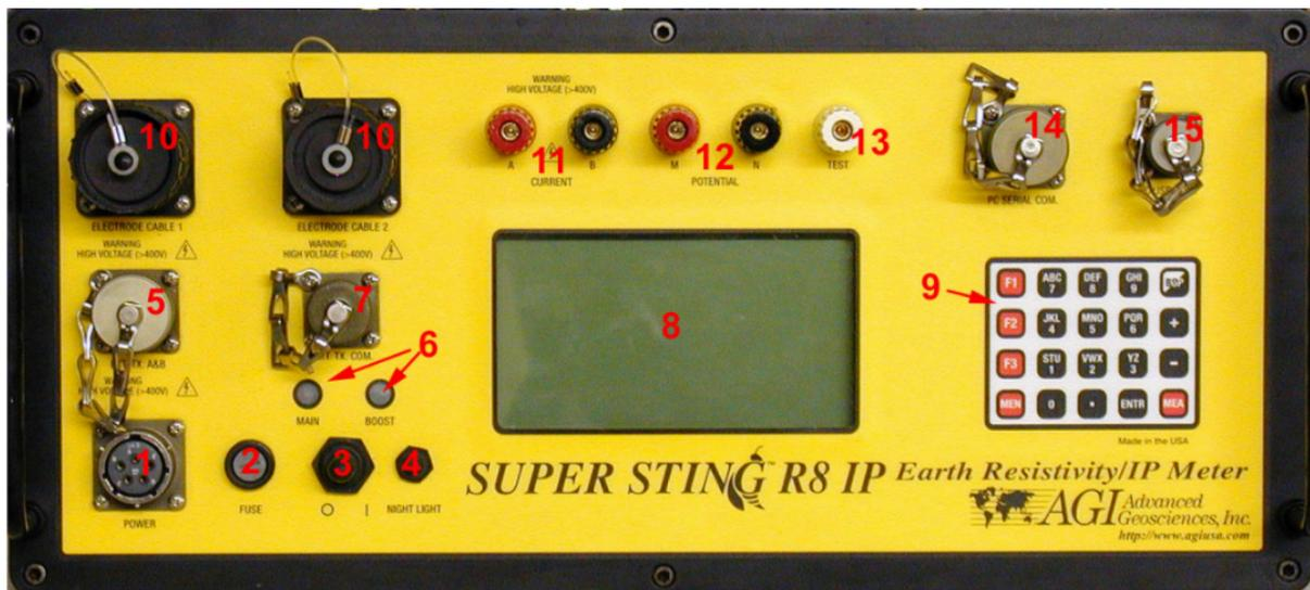
**Fig. 7.1.0 - Resistímetro SuperSting R8 [2]**
