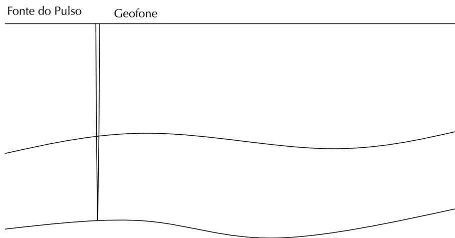
Figura 10 – Aquisição de Offset Zero
