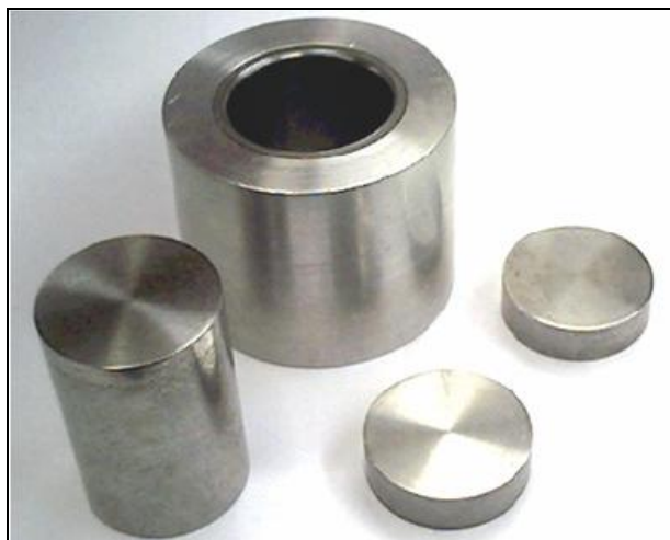
Fig. 3.3-1: Matriz e punções utilizadas para a elaboração dos alvos [36].
