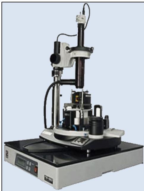
Fig. 3.8-4: Foto do SPM modelo NTEGRA utilizado para as medidas com AFM.
