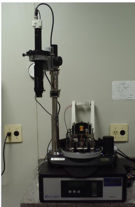
Figura 4.4: Foto de um AFM que também é usado como MFM onde foram realizadas as medidas.
