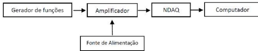
Figura 6.12: Esquema experimental para calibração do amplificador.
