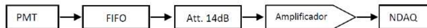
Figura 6.27: Esquema experimental de aquisição de dados do detector de nêutrons sem coincidência com os detectores cintiladores.
