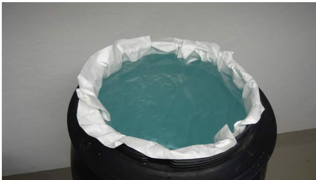
Figura 6.14: Tanque revestido com tyvek e cheio de água.
