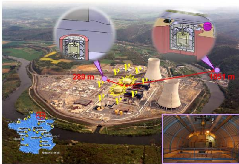
Figura 3.8: Figura mostrando a Usina na cidade de Chooz e o local exato onde cada detector de antineutrinos será instalado.
