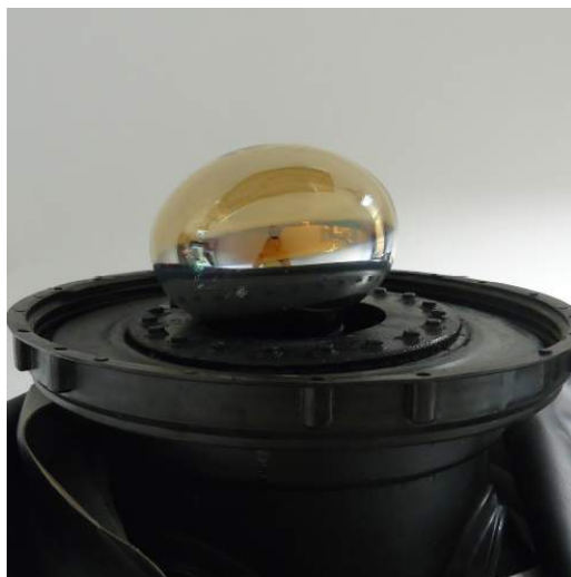
Figura 6.15: PMT que será utilizada no tanque de nêutrons.
