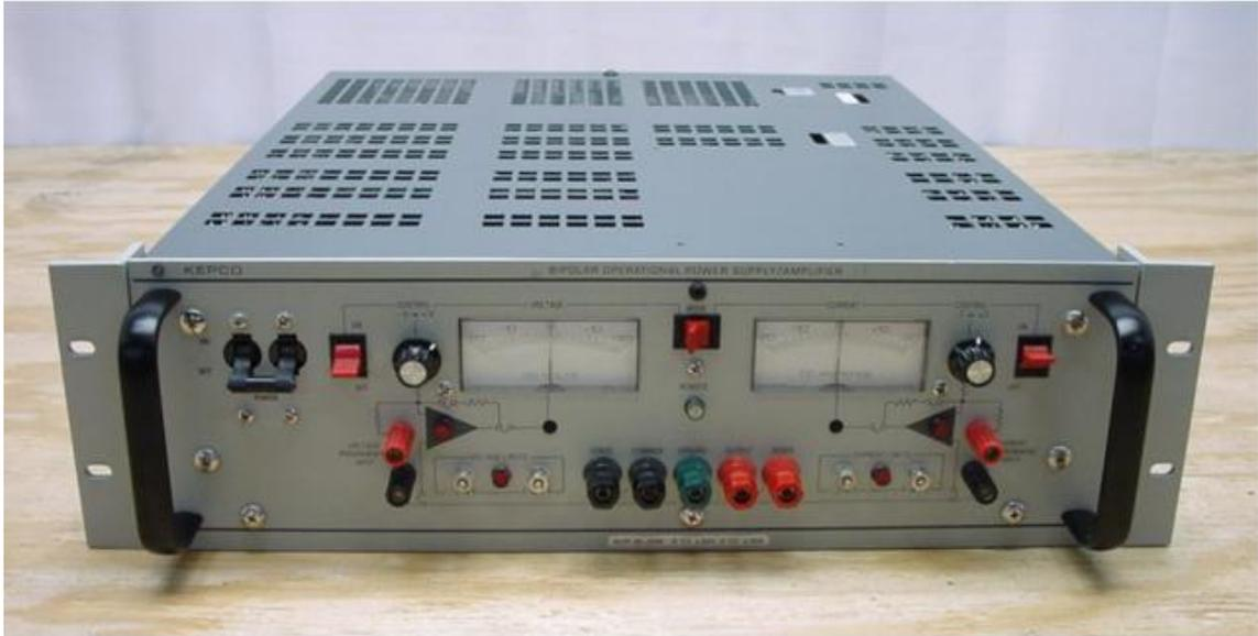
**Figura 3.18.** Fonte de corrente utilizada para gerar e controlar o campo magnético uniforme.
