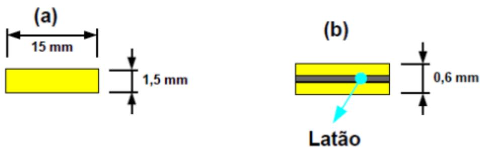
**Figura 3.27.** Segundo transdutor piezoelétrico (PZT-5J) utilizado neste trabalho, todas as dimensões na Figura estão em mm. (a) As dimensões de comprimento e largura, já (b) contém a espessura e direção de polarização das cerâmicas [34].
