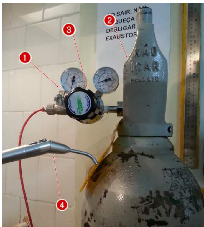
FIGURA A.3: Cilindro de gás nitrogênio N_2 . Primeiro abre a válvula 1 possibilitando a passagem do gás. Depois abre-se o cilindro usando a válvula 2. A válvula 3 é responsável pela pressão do gás que passa. Usa-se o aparelho 4 para secar as amostras. Ao acabar de usar fechar tudo e se certificar de não deixar gás preso na tubulação. Para isso, fecha-se as válvulas 2 e 3 e libera o resto do gás usando o aparelho 4. Fecha-se a válvula 1.
