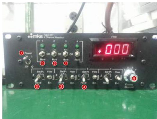
FIGURA A.5: Controlador de fluxo MKS Type 247 4 Channel Readout utilizado no controle do fluxo de H_2 e CH_4 . No botão ligamos e desligamos o MKS. Para visualizar os canais roda-se o botão 8. Para se estabelecer o fluxo do canal 1 ( H_2 ) usa-se o botão 2 e para o canal 3 ( CH_4 ) o botão 4. O botão 5 abre e fecha o fluxo do canal 1 ( H_2 ) e o botão 7 abre e fecha o fluxo do canal 3 ( CH_4 ). O botão 3 estabelece o fluxo de H_2 para o outro sistema CVD do laboratório e o botão 6 que controla a o fluxo dele.
