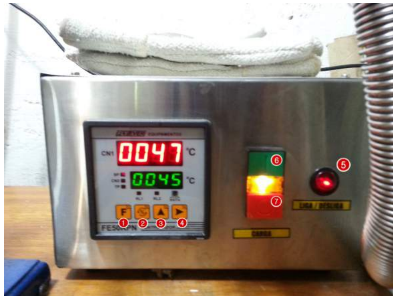
FIGURA A.8: Liga-se o forno pressionando os botões 5 e 6 (botão verde). Para ajustar a temperatura do forno pressionamos o botão 1 uma vez e no mostrador aparecerá a temperatura que está fixada. Para alterar, percorrer cada número usando o botão 4 e para mudar cada número pressionar o botão 3 quantas vezes forem necessárias. Para voltar ao display inicial, pressionar algumas vezes o botão 1. Para acionar o forno pressione o botão 2. Para desligar, pressionar o botão 2 e o 7 (botão vermelho).
