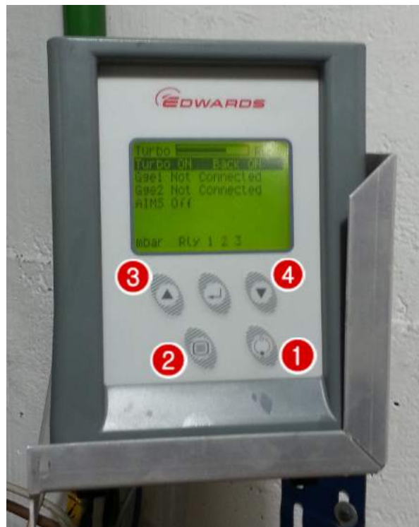
FIGURA A.7: Bomba turbo. Para ligar a bomba, pressionamos o botão 1 e na opção system pressionamos novamente o botão 1. Em seguida, descemos, usando o botão 4, até a opção turbo e pressionamos o botão 5 mais uma vez. Para voltarmos para a tela inicial, pressionamos o botão 2. Para desligar a bomba, pressionamos o botão 1 e na opção system pressionamos o botão 1 novamente. Para voltarmos para a tela inicial, pressionamos o botão 2.
