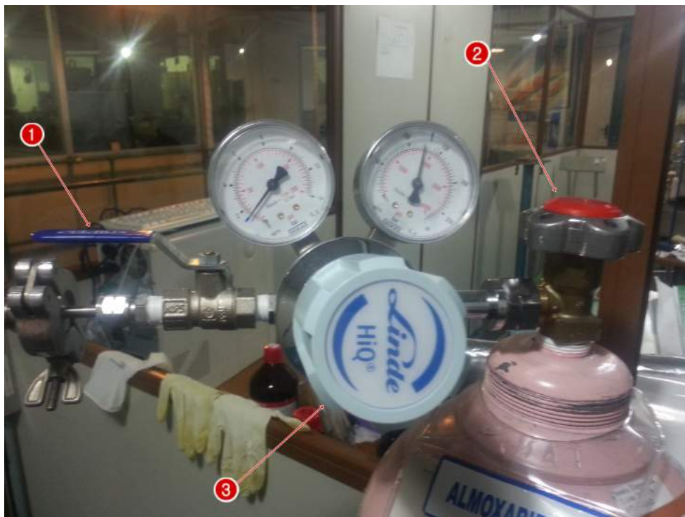
FIGURA A.6: A válvula 1 permite ou não a passagem do gás metano ( CH_4 ) para o sistema. A válvula 2 regula a quantidade de CH_4 que passa por ali. Normalmente abre-se até o risco azul. A válvula 3 abre e fecha o cilindro do gás metano.
